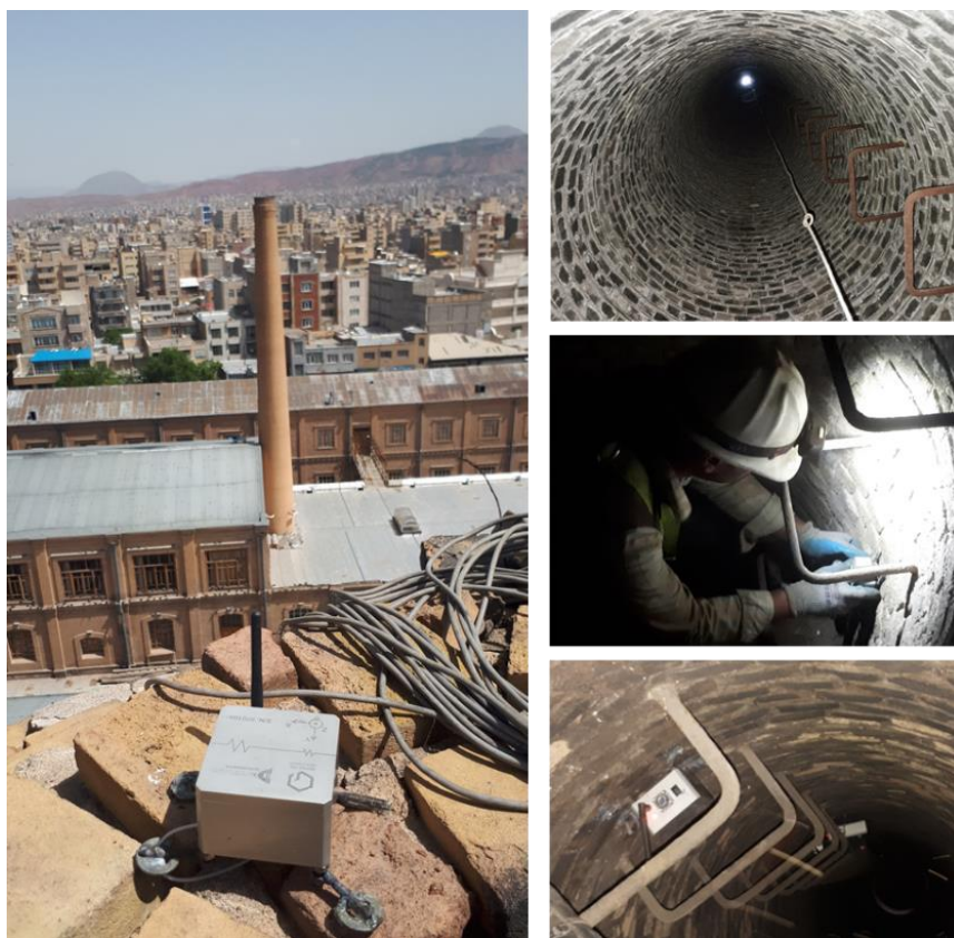
شکل ۲: مراحل تست مودال عملیاتی
