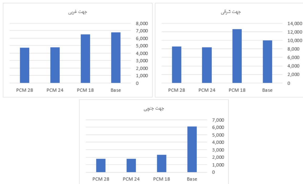
شکل ۸: مقایسه میزان مصرف انرژی در حالت پایه و دارای PCM در جهت‌های مورد بررسی در طی سال Fig 8: Comparison of the amount of energy consumption in the basic state and with PCM in the investigated directions during the year
