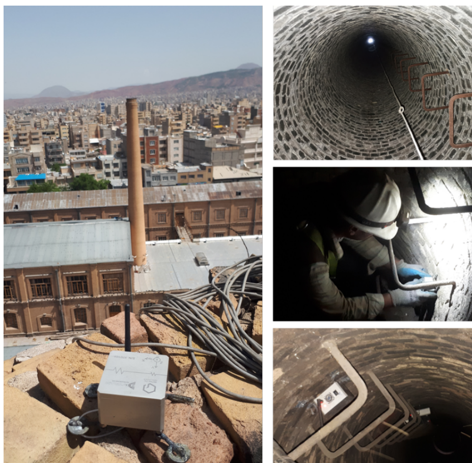
شکل ۲: مراحل تست مودال عملیاتی
